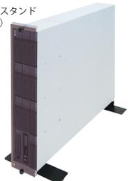
● フロントパネルを取り外すと、HDD モジュールの脱着やオペアネルでの操作が可能となります。
